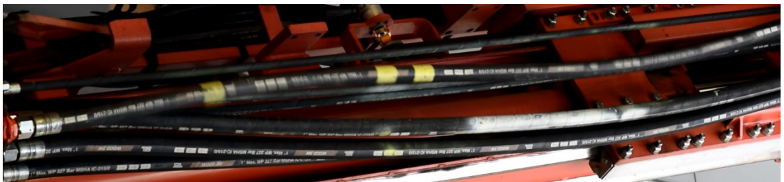
Kuva 28. Iskun linjan letkussa havaittavissa oleva aaltoliike, kun kankea porattu noin kaksi kolmasosaa. Solmukohta keltaisen teipin oikealla puolella. Vaimentimena inline-paineakku.
