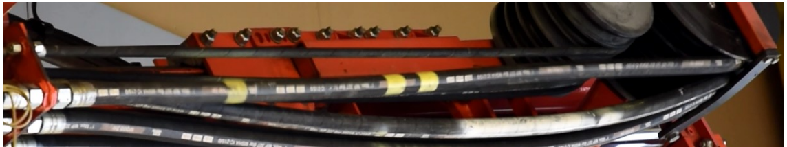
Kuva 27. Iskun linjan letkussa havaittavissa oleva aaltoliike, kun kankea porattu noin yksi kolmasosa. Solmukohta keltaisen teipin oikealla puolella. Vaimentimena inline-paineakku.
