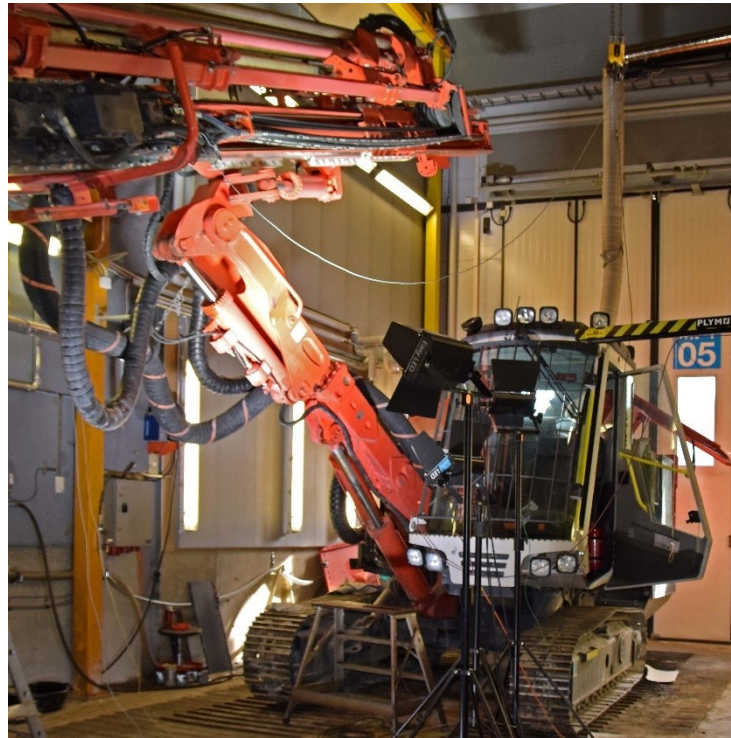
Kuva 22. DP1500i-poralaite testikammiossa tutkimuksia varten.
