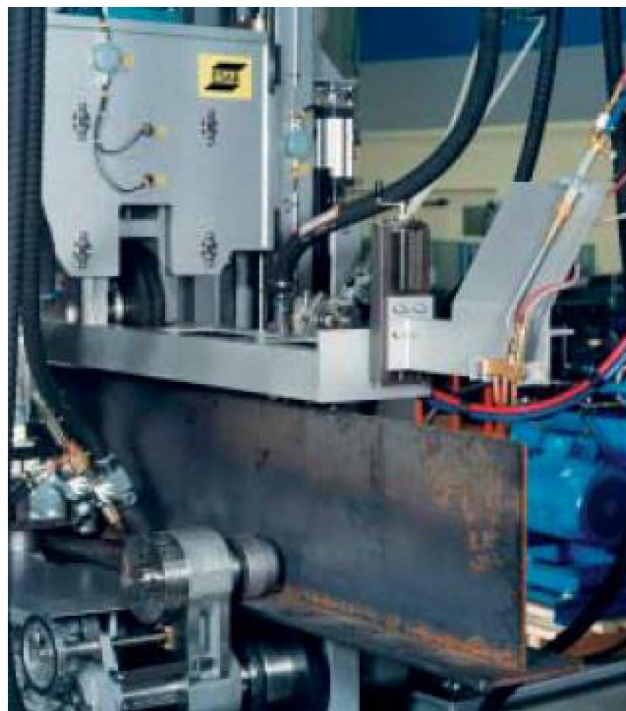
Kuva 17. Läpivirtaava T-palkin hitsausasema [29]
