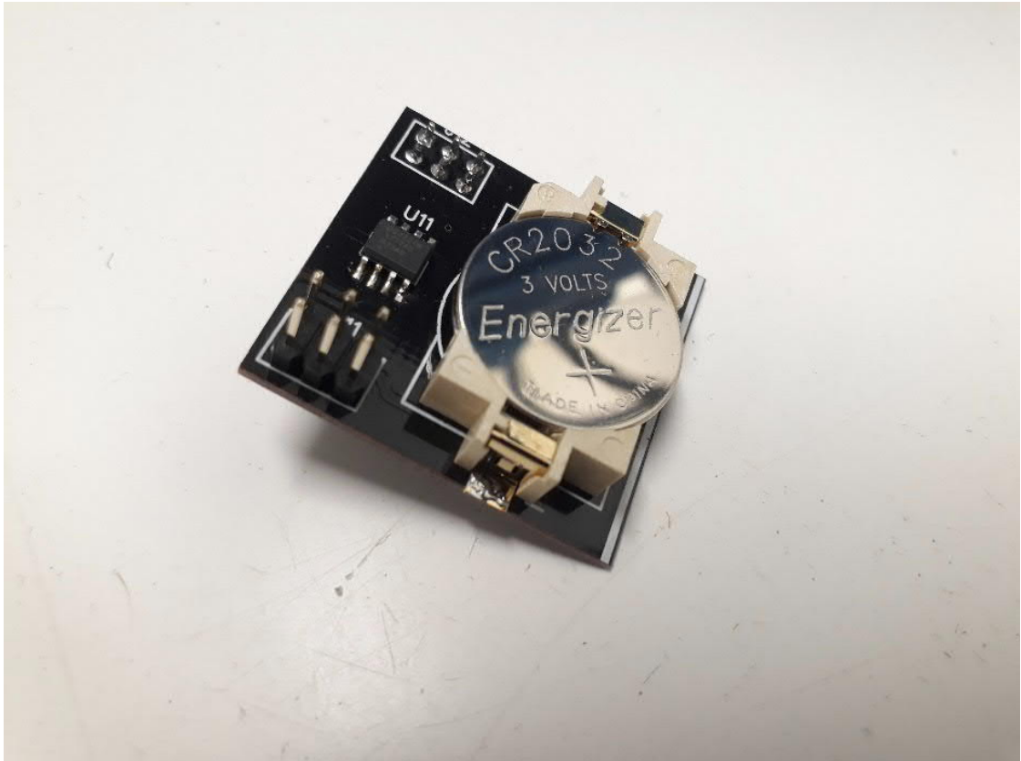
Kuva 4.2. Paine-eron mittausyksikköön lisätty kellopiiri.
