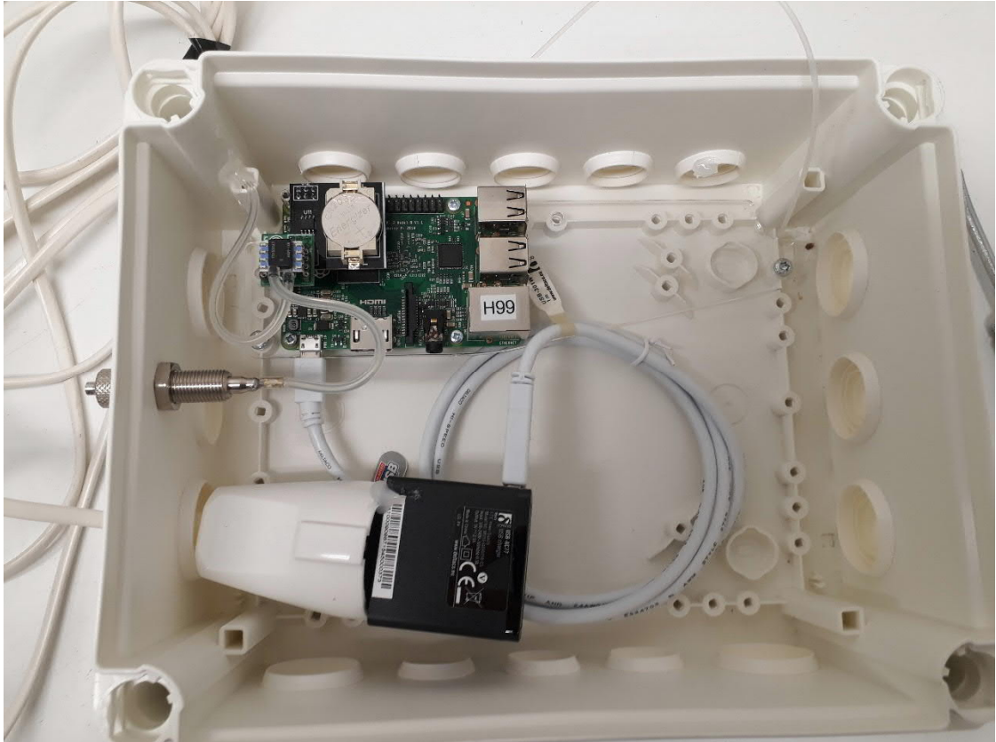
Kuva 4.3. Paine-eron mittausyksikkö, johon on asennettu kellopiiri ja poistettu modeemi.
