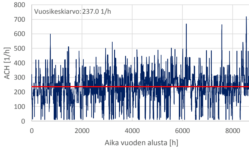
Kuva 3.6. Tuuletusvälin ilmanvaihtuvuus 48 mm paksussa puuverhotussa tuuletusvälissä. Seinä on pohjoispuoleinen ja 6,0 m korkea. Tuuletusvälin yläpää on kokonaan avoin.
