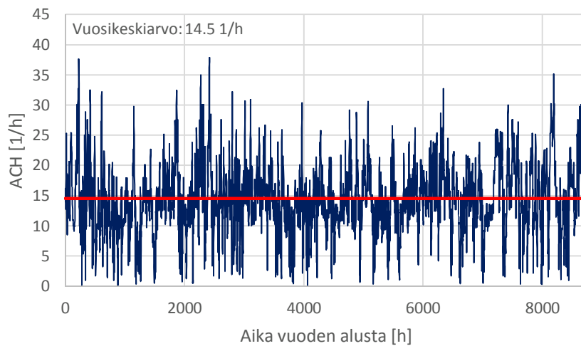
Kuva 3.13. Tuuletusvälin ilmanvaihtuvuus 30 mm paksussa tiiliverhotussa tuuletusvä- lissä. Seinä on eteläpuoleinen ja 6,0 m korkea. Tuuletusvälin yläpää on kokonaan avoin.
