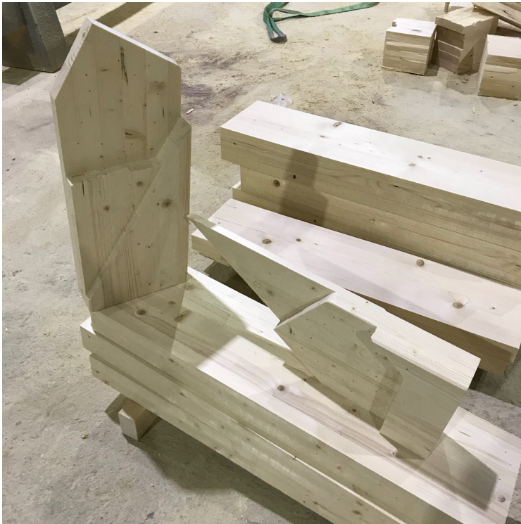
85mm vahvan räystäskaaren liitoksen mallikappale 1:1. Räystääsosissa vaakatyöstö, jossa on sisänurkka, jää näkyviin ja vaatii työstötarkkuutta. Sisäkaarien nurkan vahvuus on 120mm ja niissä työstö jää puun sisään. Liitoksen keskellä oleva vaakaosuus tarvitaan pystysuuntaisen tukireaktion siirtämiseen.
