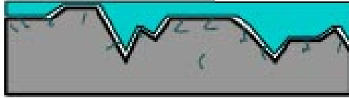
Kuva 13. Silikonin tunkeutuminen paperiin [30]
