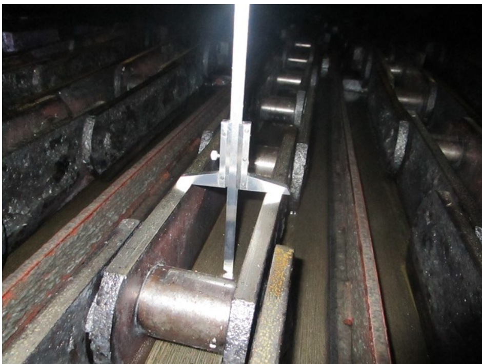
Kuva 57. Ketjun ja pohjan kuluman mittaaminen Kaukaalla. (Raumaster 2018)
