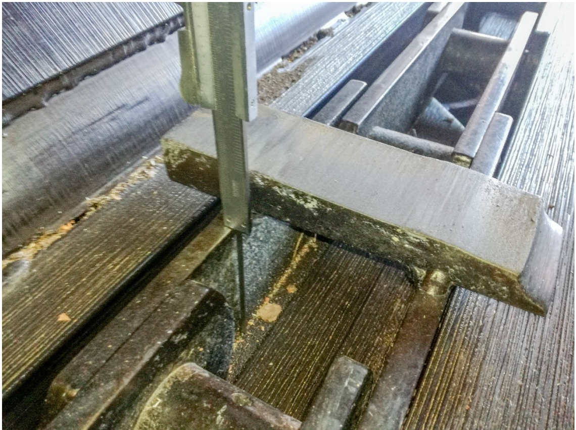
Kuva 64. Ketjun sivulevyn korkeuden mittaus.
