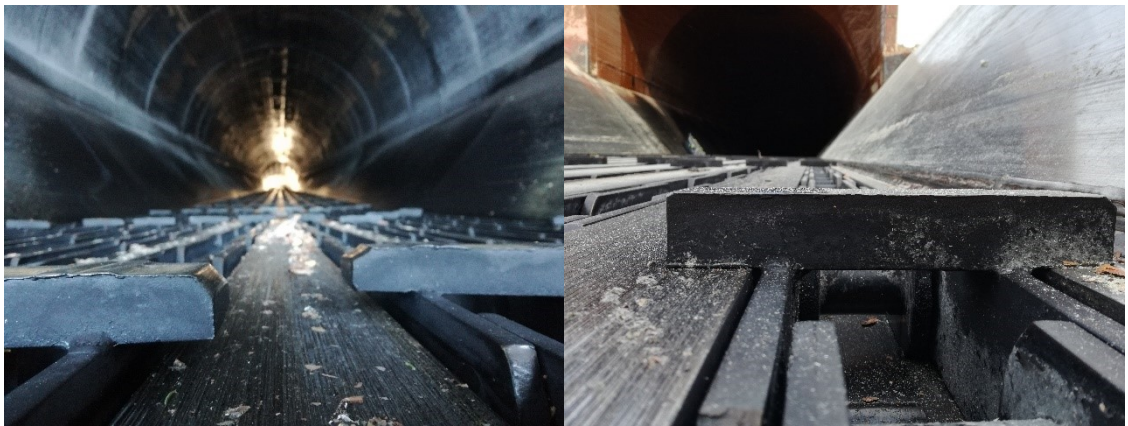
Kuva 39. Pietarsaaren kuljettimissa (vas.) kola on selkeästi korkeammalla kuin Kaukaan kuljettimissa (oik.).
