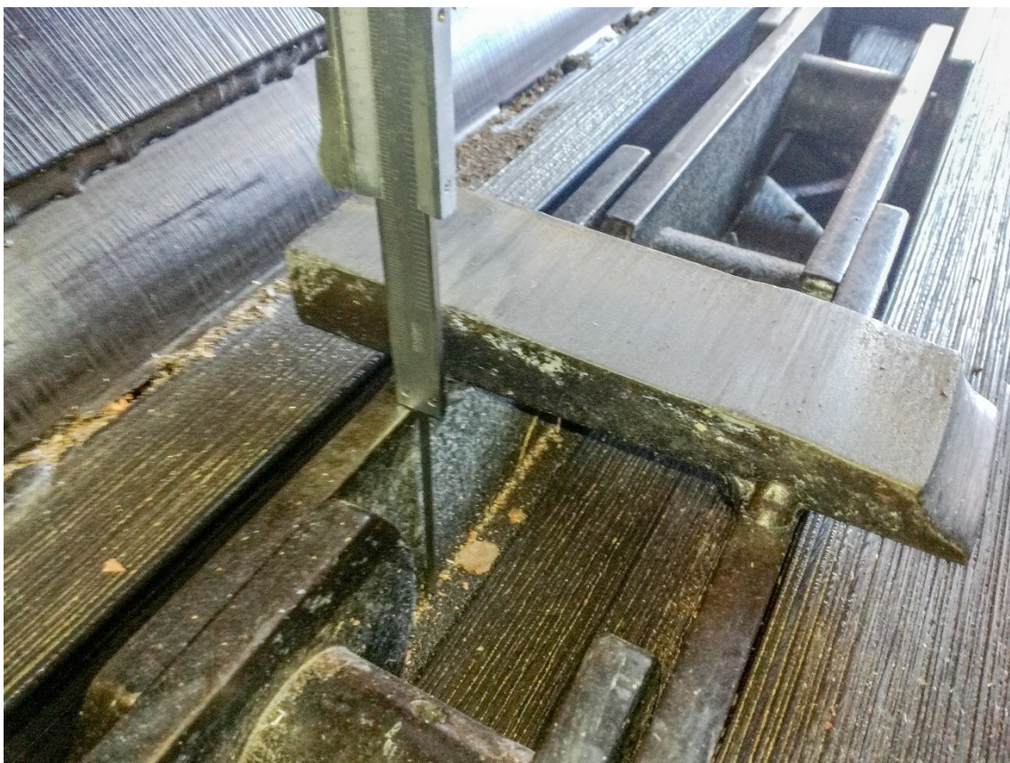
Kuva 62. Ketjun sivulevyn korkeuden mittaaminen työntömitalla.
