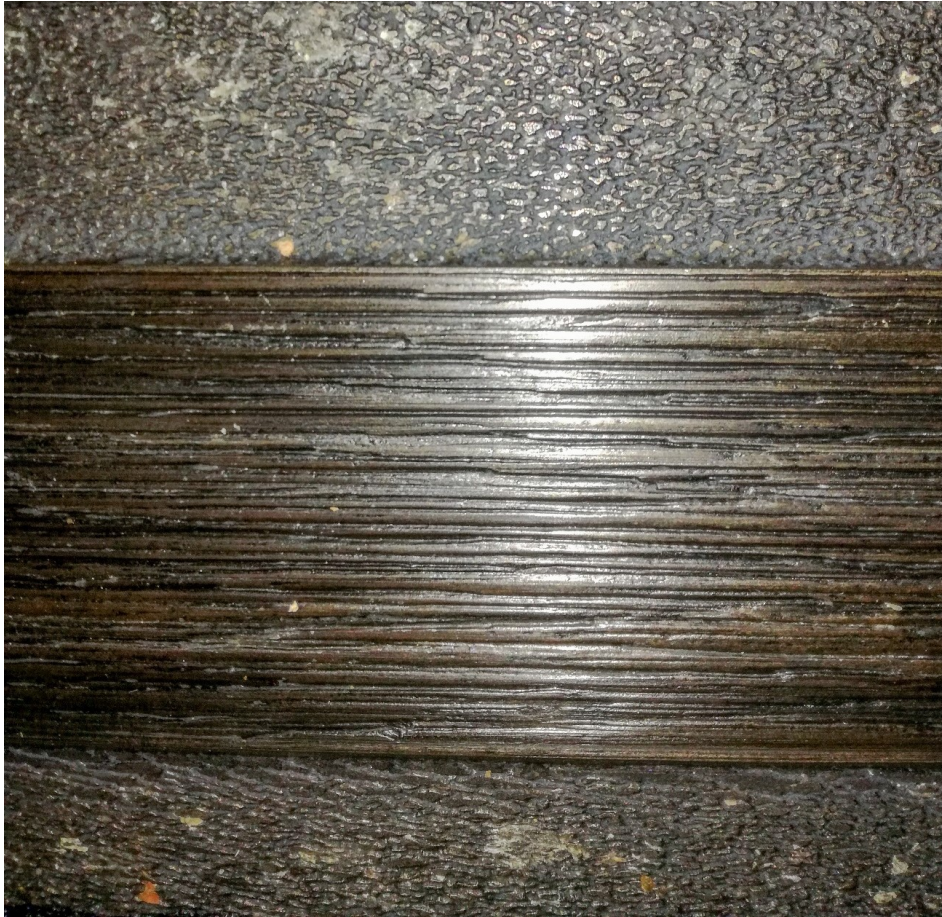
Kuva 51. Sulatuskuljettimen pohjan kuluminen kuljettimen loppupäässä.
