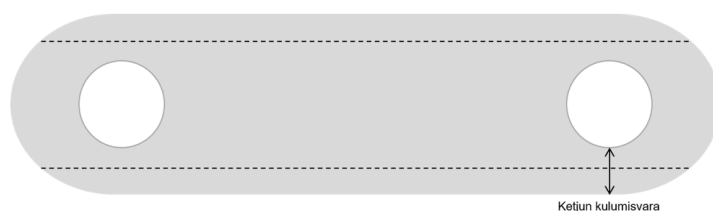
Kuva 59. Ketju on vaihtokunnossa, kun 50% sivulevyn kulumisvarasta on kulunut. (Mukaiillen Lapua-Ketjut, n.d.)
