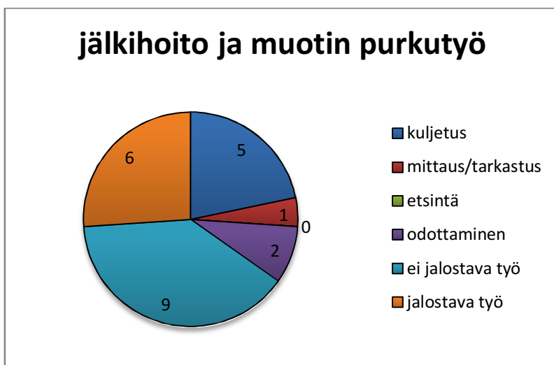
Kuva 18. Hukat jälkihoidon ja muotin purkutyön aikana
