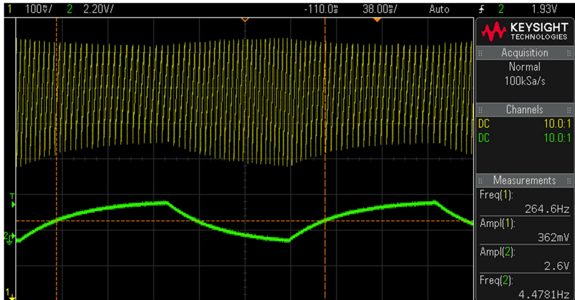
Kuva 23: Integroidun kanttiaallon vaikutus ramppioskillaattorin taajuuteen
