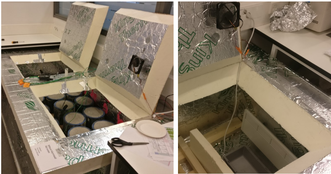
Kuvat 4.5 a ja b. Kuvassa a (vasemmalla) koekappaleiden sijoittelua olosuhdearkkuun ja kuvassa b (oikealla) olosuhdearkun lämmitin ja suhteellista kosteutta ylläpitävä suolaliuosastia.
