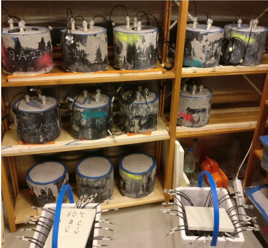
Kuva 4.2. Koekappaleiden säilytys olosuhdehuoneessa. Kuvan alareunassa kylmälaukuissa tasaantumassa olevia näytepalamittauksen koeputkia mittapäineen.
