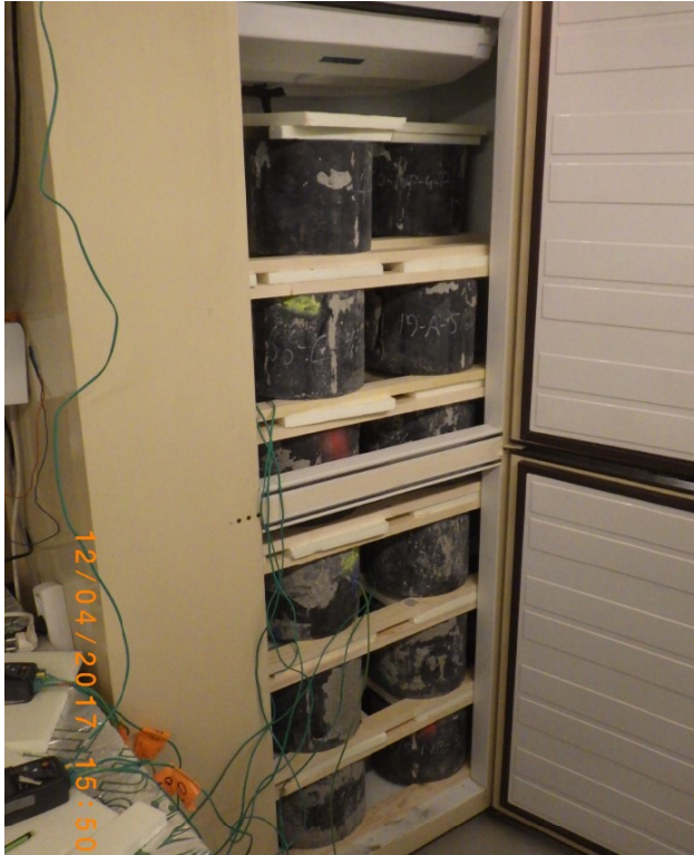
Kuva 4.1. Viileän olosuhteen aikaansaamiseksi hankittu kylmiö. Pällekkäisten koekappaleiden välissä on säteilysuojana 20 mm eristelevy. Lisäksi koekappaleiden ylä- ja alapuolella on 22 mm rimat, jotka mahdollistavat ilman kiertämisen koekappaleiden pinnoilla ja siten koekappaleiden kuivumisen kahteen suuntaan.
