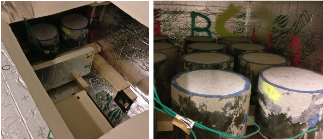
Kuva 4.6. 60 °C olosuhdearkku. Vasemmanpuoleisessa kuvassa arkun ilmankierrosta vastaavat tuulettimet, säteilysuoja ja lämmönlähteenä toiminut miniuuni. Oikealla kuva arkkuun sijoitetuista koekappaleista.
