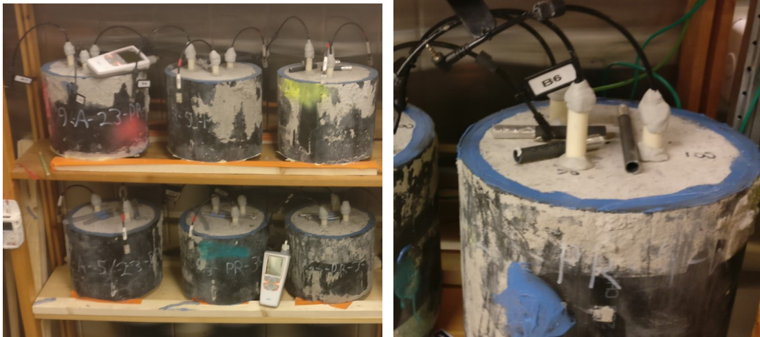
Kuva 4.15. Vasemmalla mittapäitä tasaantumassa porarei'issä ja oikealla tarkemmin esillä mittausputken yläpään tiivistys. Koekappaleiden päällä on mittauksen ajaksi pois-tetut sisäputket.
