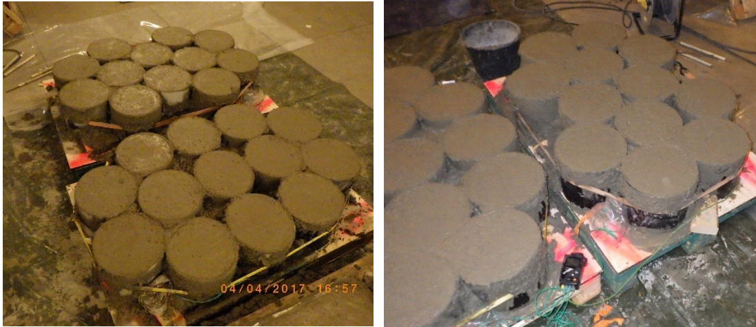
Kuva 4.9. Valettuja ja hierrettyjä koekappaleita ennen jälkihoidon aloitusta.
