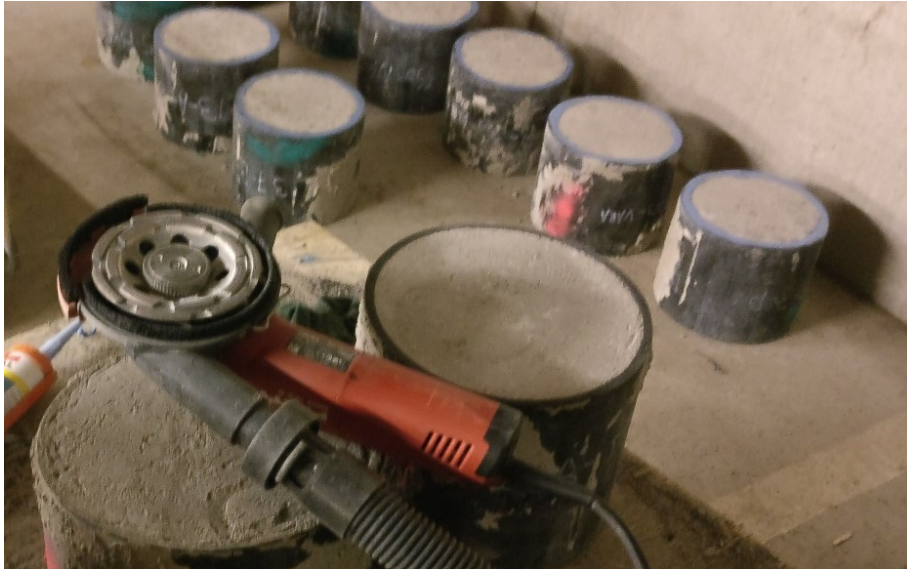
Kuva 4.11. Kuvassa hiomaton ja hiottu koekappale, sekä lattialla kuvan yläreunassa tiivistettyjä koekappaleita. Tiivistys näkyy kuvassa sinisenä kaistana betonin ja muotin rajapinnassa.
