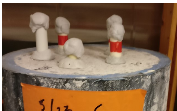
Kuva 4.17. Varmistusmittausten mittausputket koekappaleen etuosassa. Punaisella teipatut mittausputket ovat alkuperäisiä mittausputkia, joista suhteellista kosteutta on mitattu toistuvasti.
