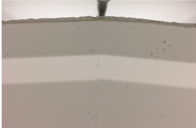
Kuva 62. HI-palkin harja-alue on ehjä ja halkeilematon.
