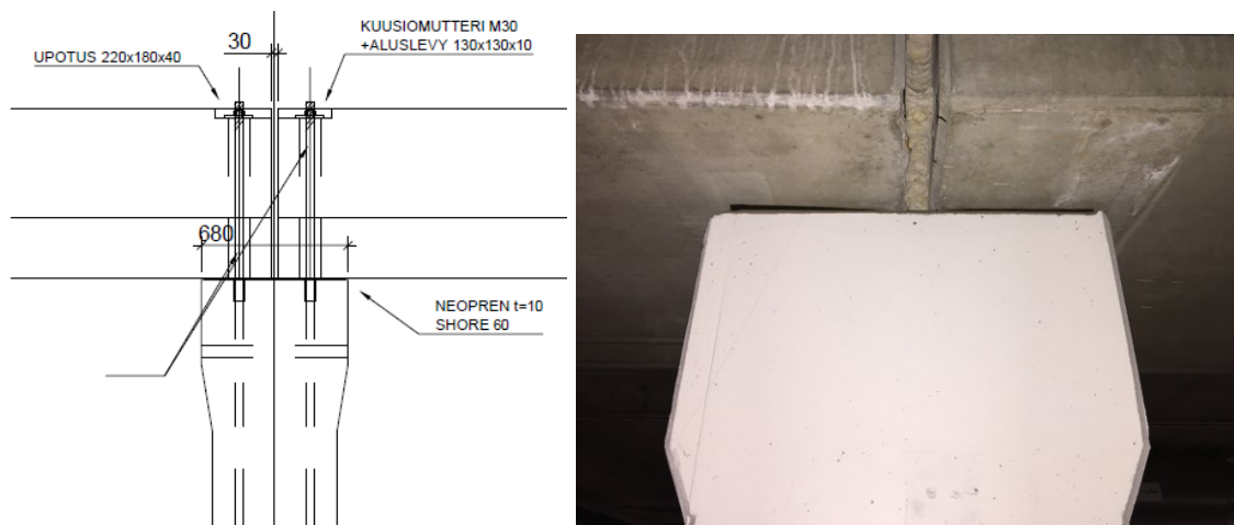
Kuva 61. Leukapalkin liitos välipohjaan päättyvään pilariin.
