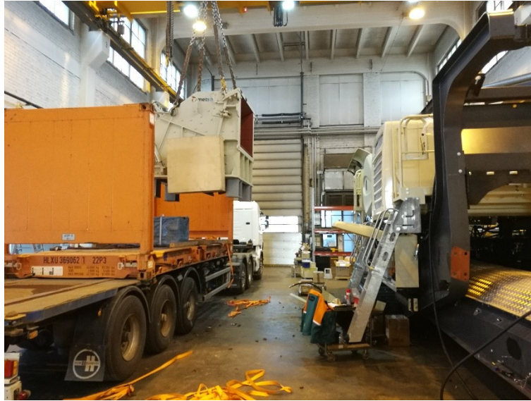
Kuva 12. Murskan nostaminen alas G-hallissa. (Kuva: Jani Kohtamäki).
