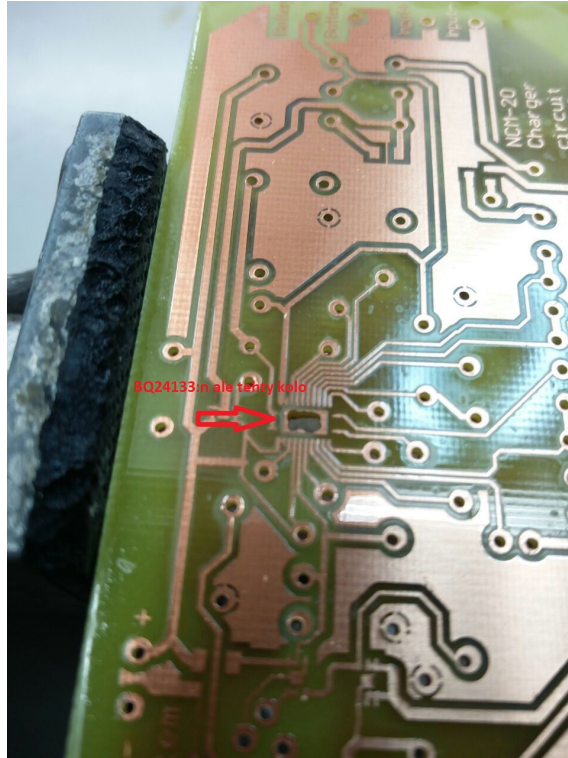
Kuva 14 BQ24133 alle porattu reikä kuvattuna levyn yläpuolelta
