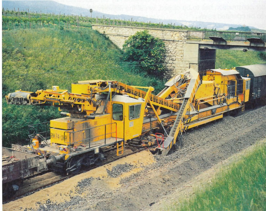
Kuva 24. Sepelinpuhdistuskone työssä. (Lichtberger 2011, s. 546)
