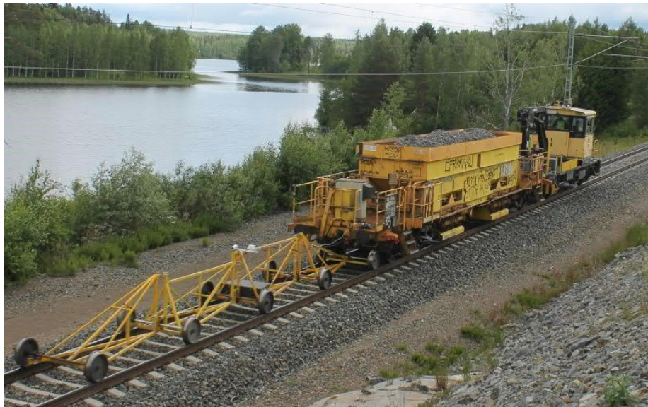
Kuva 18. Jatkuvatoiminen taipumamittauslaite Stiffmaster kiinnitettynä sepelivaunuun. (Luomala et al. 2017, s. 284)
