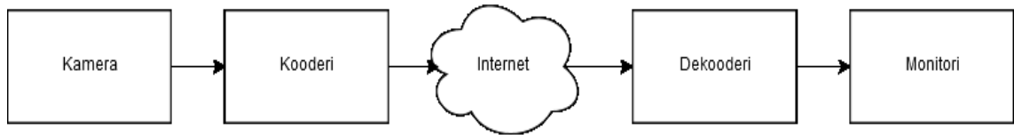
Kuva 4: Kooderin ja dekodeerin sijainti videodatan siirrossa
