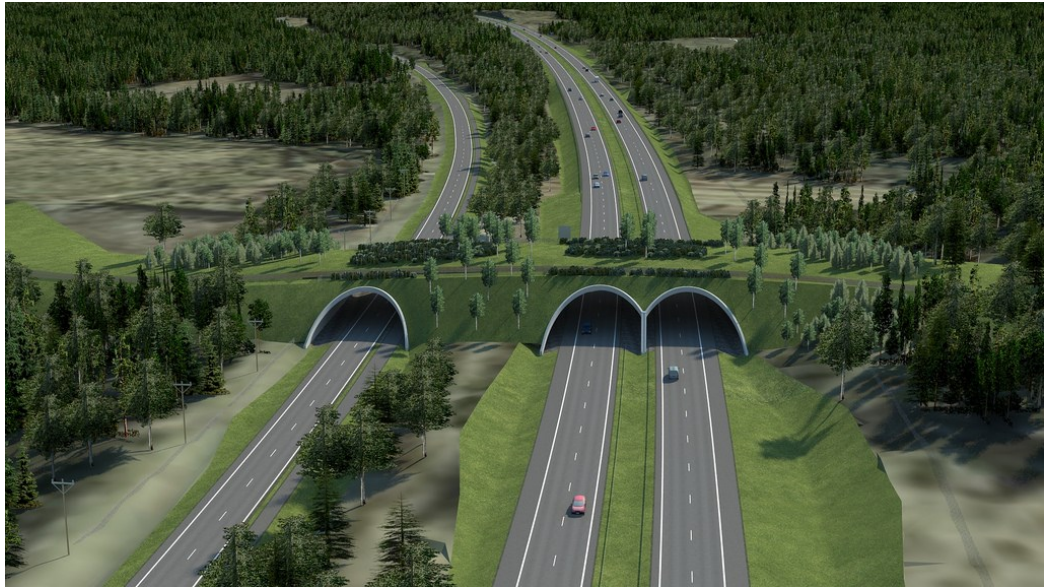
Kuva 6: Suunnitelma vihersillasta E18 Hamina–Vaalimaa hankkeessa (Liikennevirasto 2017)
