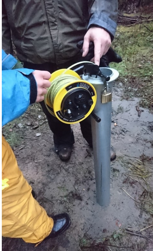
Kuva 5. Pohjaveden pinnankorkeuden mittaus (Savonia 2016)
