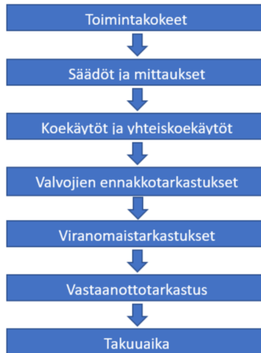
Kuva 3. Taloteknisten töiden vastaan- ja käyttöönottoprosessin vaiheet (Viholainen 2016)
