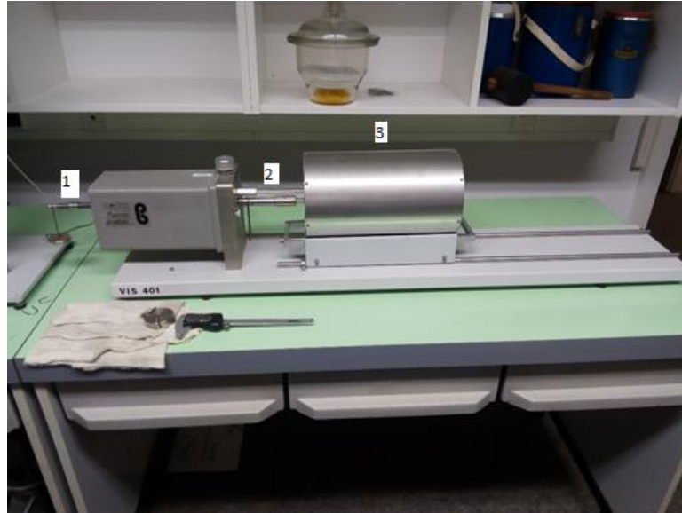
Figure 14. Beam-bending viscometer BÄHR Thermoanalyse VIS 401.
