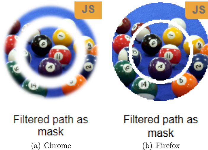
Kuva 4.16 Testitaulukon solun C8 toiminta Chromessa ja Firefoxissa. Firefox ei tuota pehmeää reunaa kuvalle kuin kuuluisi, vaan tulos on roisoinen ja terävä.
