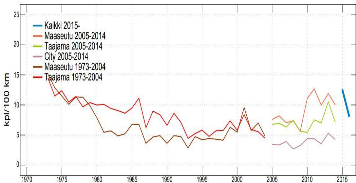
Kuva 13. Energiateollisuuden (ET) keräämät vikakeskeytystaajuudet KJ-verkoissa aikakausittain ilman jälleenkytkentöjä. Muokattu lähteestä (Energiateollisuus 2017)
