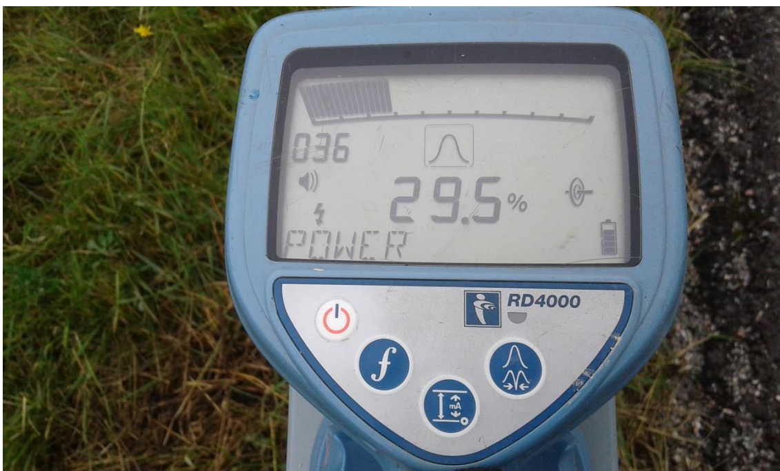
Kuva 9. Kaapelien etsimistä RD4000-kaapelitutkalla huippuvastemenetelmällä.
