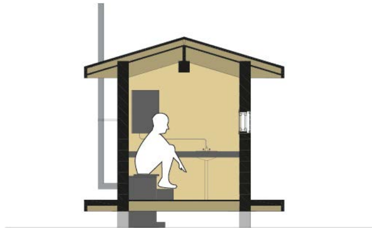
Kuva 62. Leikkauskuva suunnitellusta ergonomisesta ulkokäymälästä
