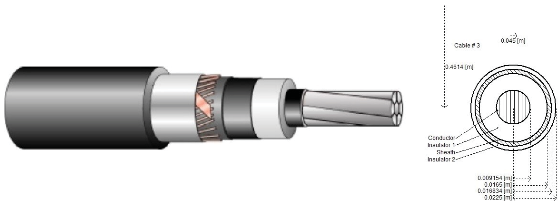
Kuva 43. 1-johtimisen 20 kV AHXCMK-WTC-kaapeli ja PSCAD:n kaapelin malli. Muokattu lähteestä [46].
