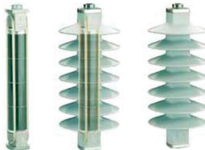
Kuva 28. ABB:n POLIM-D-tyyppinen keskijänniteylijännitesuoja. Vasemmalla aktiivinen osa ennen kuoren valamista. Keskellä havainnekuva, jossa näkyy aktiivinen osa silikonikuoren sisällä. Oikealla valmis ylijännitesuoja. [37]
