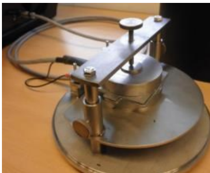
Kuva 41. Hot Disk TPS 2200 S -laitteisto: vasemmalla näytteenpidin, oikealla mittausvirtalähde ja kannella peitetty näytteenpidin. Laitteistoon oli liitetty myös tietokone USB-kaapelilla.
