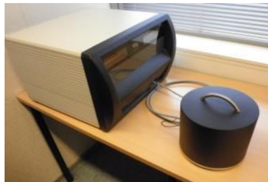
Kuva 41. Hot Disk TPS 2200 S -laitteisto: vasemmalla näytteenpidin, oikealla mittausvirtalähde ja kannella peitetty näytteenpidin. Laitteistoon oli liitetty myös tietokone USB-kaapelilla.
