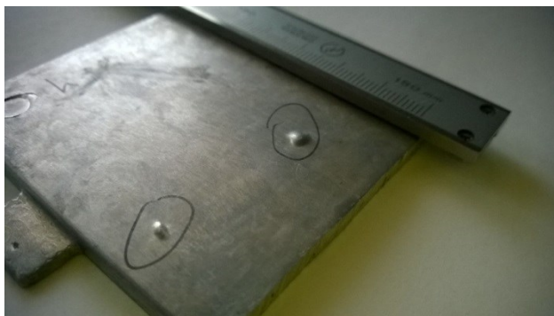
Kuva 18. Lämpökäsittelyn aikana painevalukappaleen pinnan läheisyydessä olevien huokosten sisältämät kaasut laajenevat ja muodostavat rakkuloita. Huokosten kaasunpaine riittää deformaamaan niitä ympäröivää metallia.
