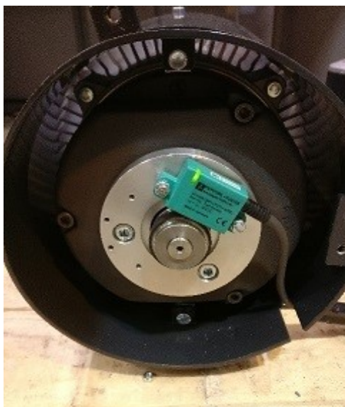
Kuva 26. Pulssianturi 1:n kiinnitys mittauksia varten.
