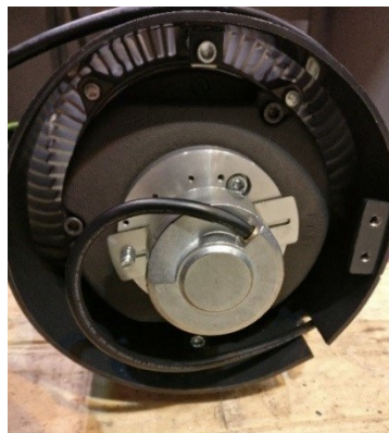
Kuva 37. Pulssianturi 2 kiinnitettynä moottorin akseliin mittauksia varten.
