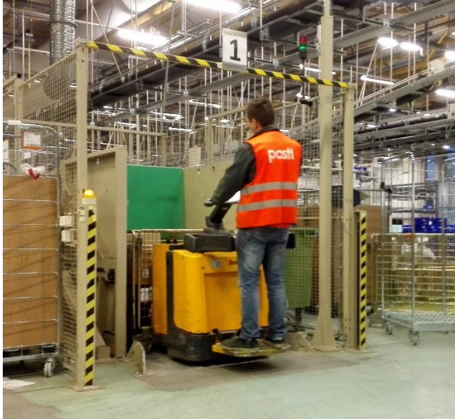
Kuva 1: Kuljetusyksikön syöttö lavansiirtovaunulla kaatolaitteeseen.
