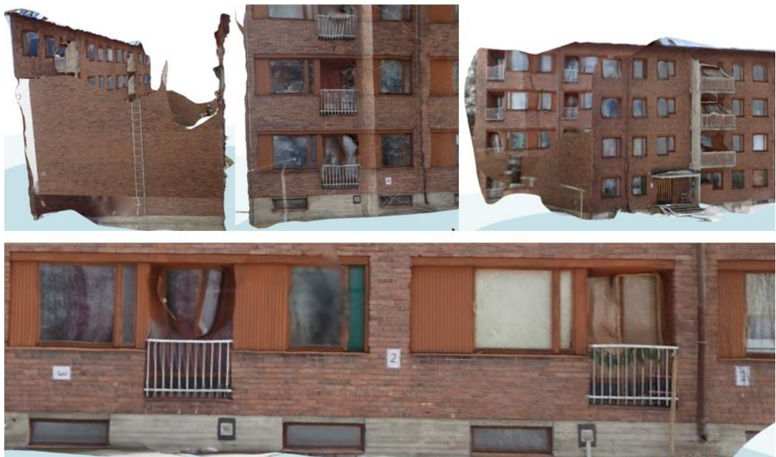
Kuva 41 Pilottikohteen 3D-malli Remake ohjelmalla.
