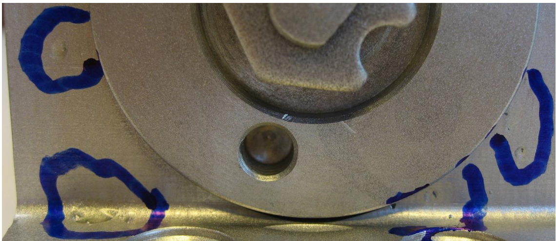
Kuva 29. Vuotoja rungon koneistetulla ja maalatulla päätypinnalla.
