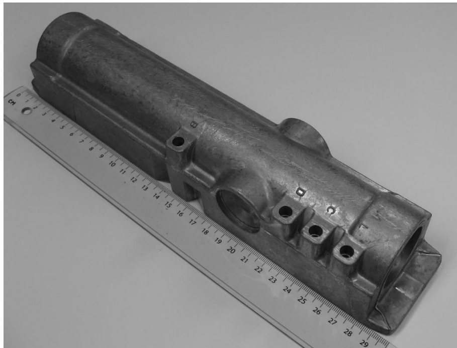
Kuva 12. Rungon valuaihio, josta on poistettu valukkeet ja purseet.
