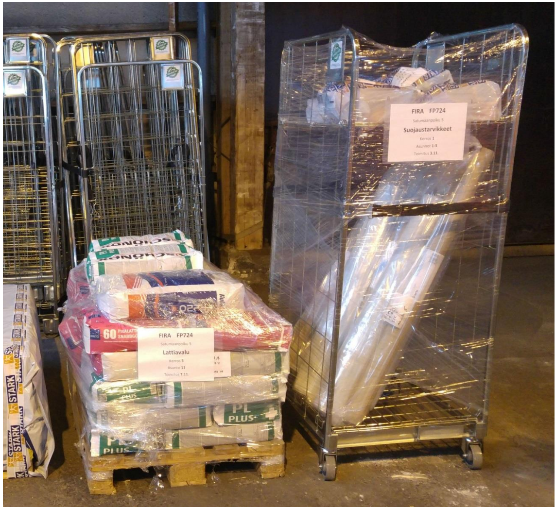
Kuva 5. Oikealla olevassa rullakossa on osa yhden kerroksen suojausmateriaaleista ja vasemmalla lavalla yhden asunnon toinen toimituserä. Kuva on otettu tavarantoimitajan varastolta noin kaksi viikko ennen ensimmäisen erän toimitusta. (kuva: Juho Tilli)
