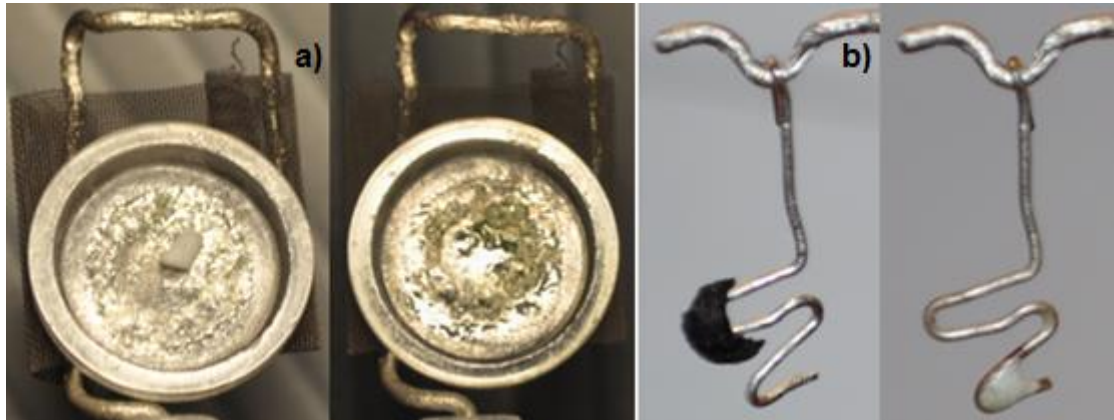
Kuva 3.21 a) KOH-näyte kupissa ja b) mustalipeänäyte platinakoukkuun ripustettuna ennen ja jälkeen palamisen.
