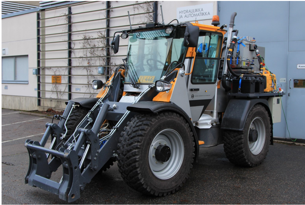
Kuva 4.1. Mittauksissa käytettävä muunneltu Wille 655 C -taajamakone. Päästömittausjärjestelmä on asennettu takarungon päälle.
