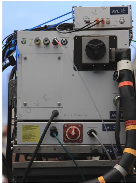
Kuva 3.1. Keskellä GAS PEMS, ylhäällä järjestelmää ohjaava PC, alhaalla virtalähde.
