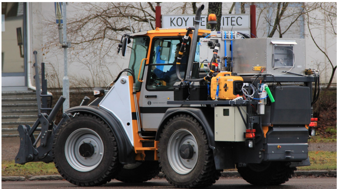
Kuva 3.4. Päästömittauslaitteisto, polttoaineen tilavuusvirran mittausyksikkö, polt-toakaasu, akusto ja generaattori koneen kyhdissä.
