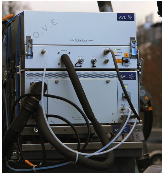
Kuva 3.3. Pienhiukkaspäästöjen mittalaitteet. Ylempi laite mittaa noen pitoisuuden ja alempi pienhiukkasten massan.
