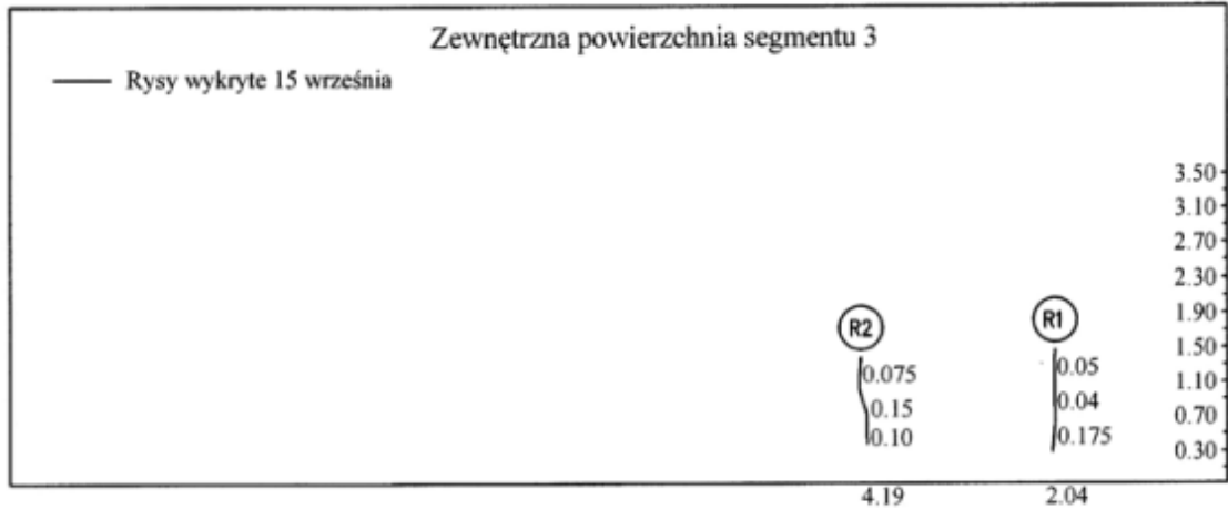
Rys. 16. Układ rys na zewnętrznej powierzchni segmentu 3 Fig. 16. Location of the cracks on the outside surface of the wall segment 3
