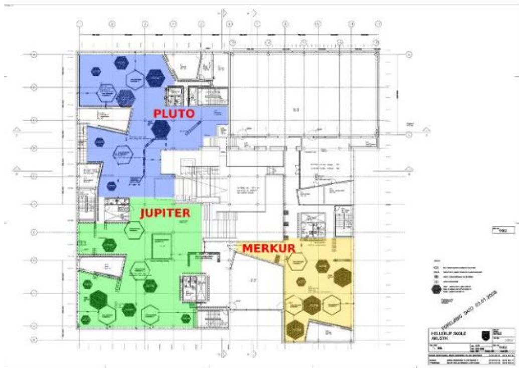
Kuva 2.3. Hellerupin koulun ensimmäisen kerroksen pohjapiirustus, Tanska. Kuvassa eri avoimet oppimisympäristöt on esitetty eri väreillä [11].
