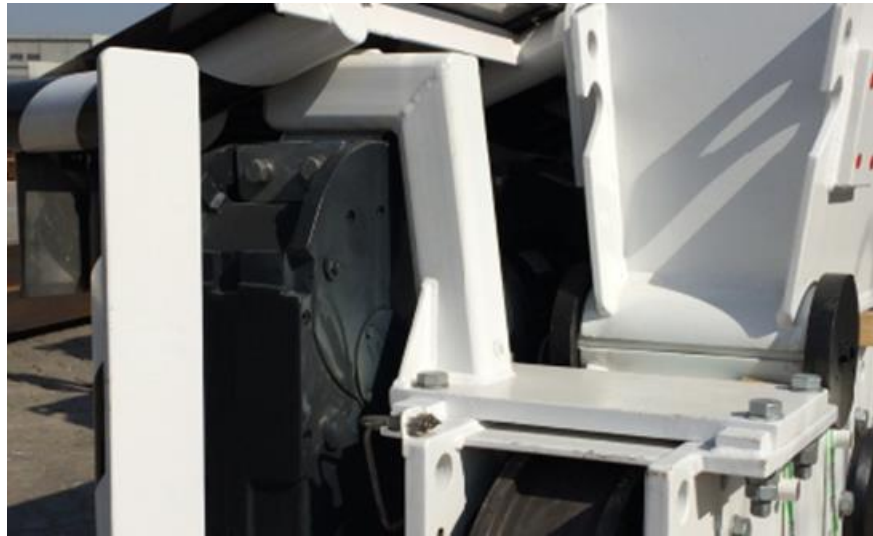
Kuva 40. Momenttituki, joka on usein sijoitettu telivaunun päälle.
