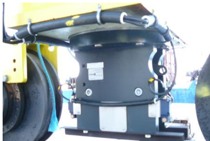
Kuva 46. Kiskojarru on sijoitettu telissä toisio- tai härkävaakaan riippuen layoutista.
