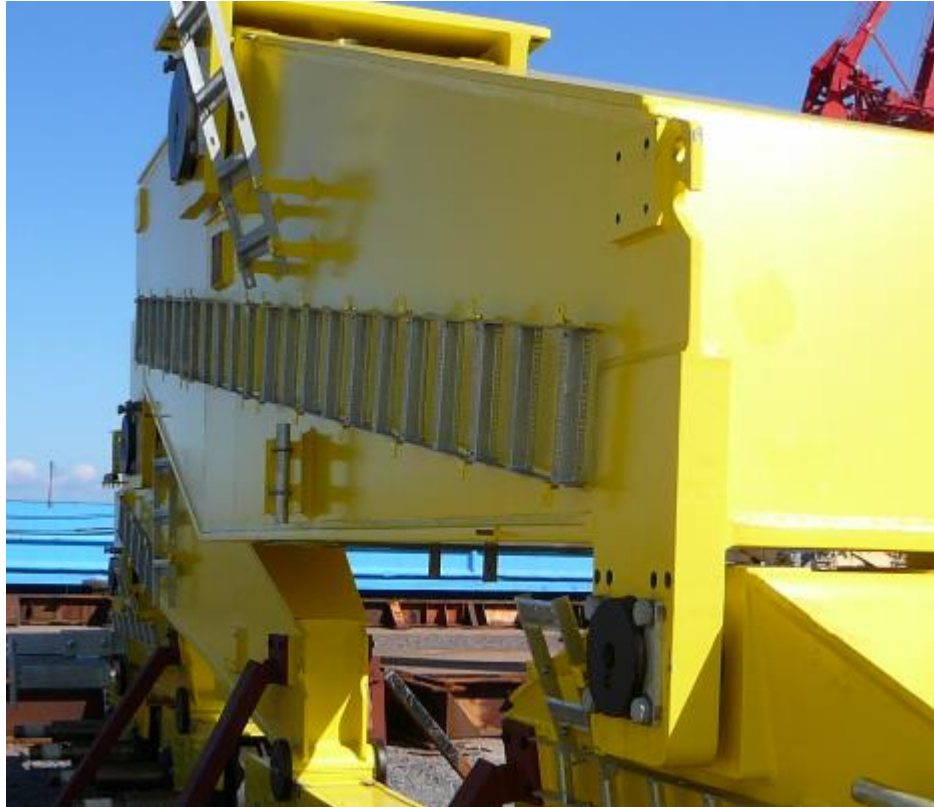
Kuva 43. Telien kaapelitiet ongelma vinoissa seinämissä
