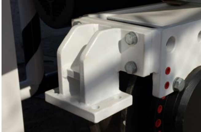
Kuva 47. Pyöräjarrulle varattu kiinnityspaikka telivaunussa.
