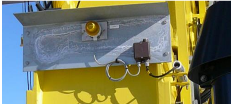
Kuva 45. Kuvassa on nosturin siirron käyttövalo ja paikka myös summerille.
