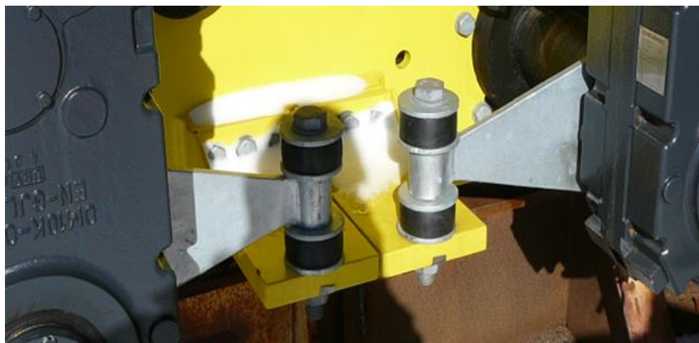
Kuva 41. Kuvassa on esitetty toinen momenttituki vaihteelle.
