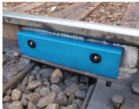
Kuva 39. Salient Systemssin L/V Module mittaa sivusuuntaisen voiman suoraan kiskon varresta venymäliuskoilla [29]
