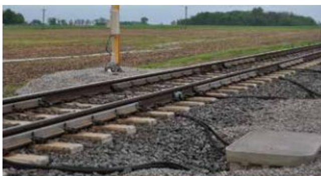
Kuva 25. Salient Systemssin wild-järjestelmä, jossa venymäliuskat ja niitä suojaava kotelointi on kiinnitetty suoraan kiskoon. [40]
