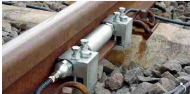
Kuva 27. Lascan laserlähetin koteloituna. [2]
