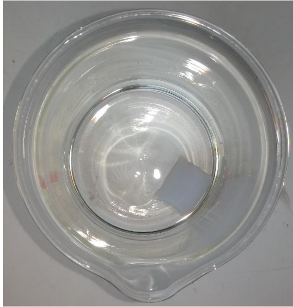
Kuva 7.14. TEOS-etanoli-vesiliuoksessa vanhennettu geeli ennen ylikriittistä kuivausta.
