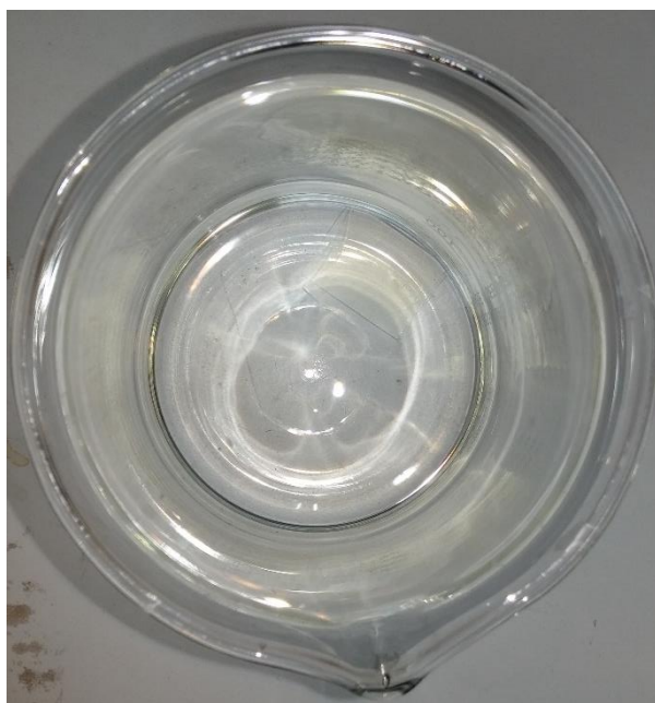
Kuva 7.10. Etanolissa vanhennettu geeli, jolle on tehty myös liuotinvaihto, ennen ylikriittistä kuivausta.
