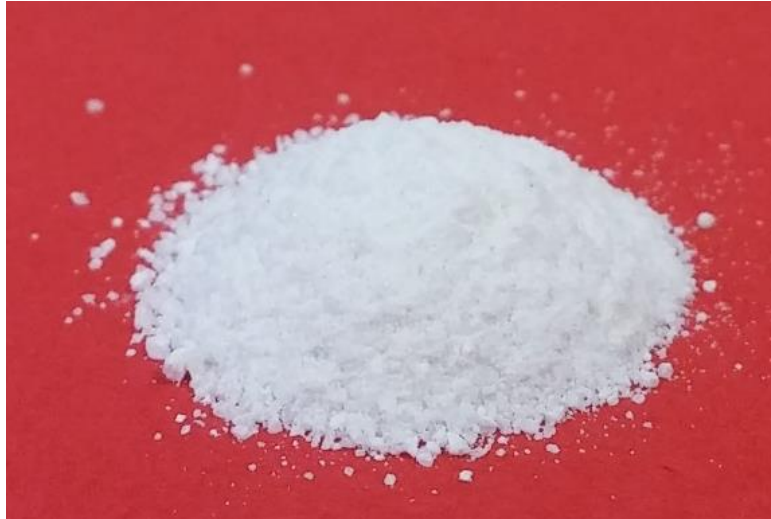
Kuva 7.1. Käsitelty ja kuivattu näyte, joka oli valmistettu käyttäen käsittelylämpötilaa 70 °C, painetta 15,0 MPa ja käsittelyaikaa 300 minuuttia.
