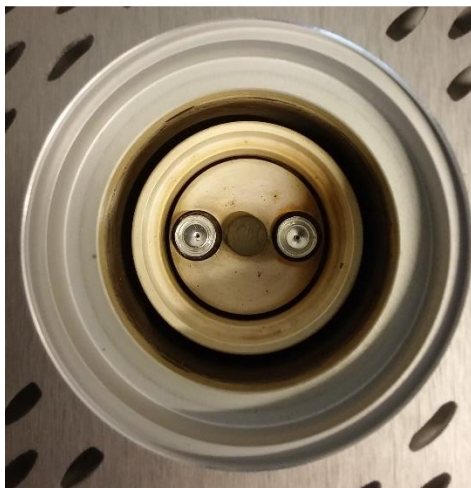
Kuva 6.6. DSC mittauskammio, jossa on vasemmalla tyhjä referenssinäyte ja oikealla mitattava näyte.
