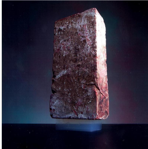
Kuva 5.2. Piidioksidi aerogeeli, jonka paino on 2 g, kannattelee 2,5 kg tiiltä. [23]
