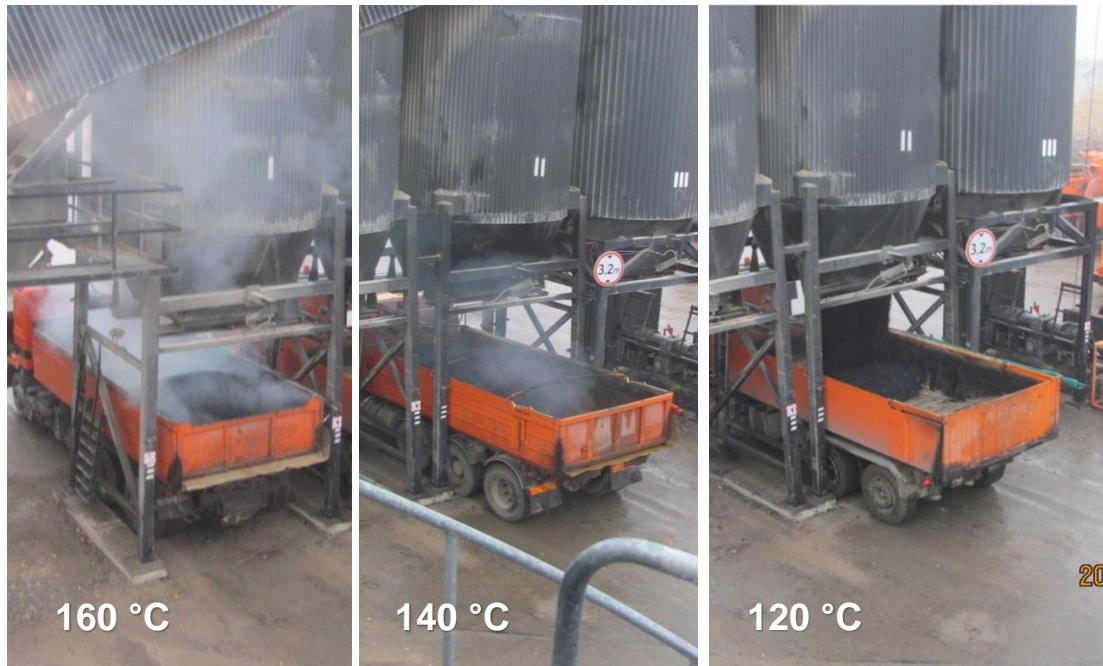
Kuva 8. LTA:n kuormaus asfalttiasemalla eri lämpötiloissa (J. Pohjola, LTA-esitelmä, Oulu 19.8.2015).
