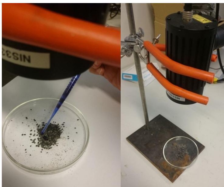
Kuva 24: Kvalitatiivisen fotoaktiivisuusmittauksen koejärjestely, Resazurinin asettaminen ja UV-lampun sijainti
