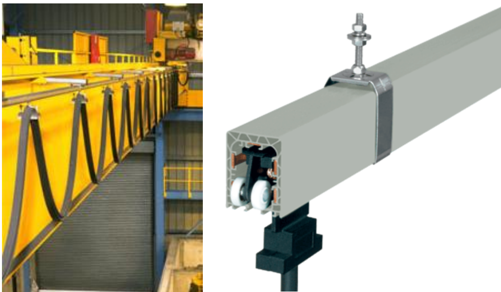
Kuva 15 Riippukaapeli ja virtakisko [32,33]
