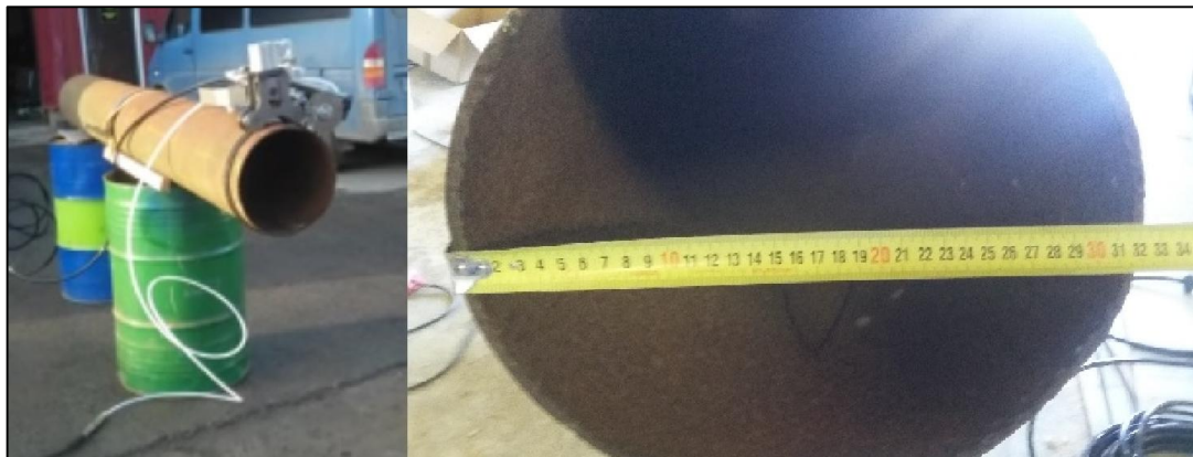
Kuva 63. Paalun vaakasuuntainen kiinnitys (vasemmalla) ja paalun poikkileikkaus (oikealla).
