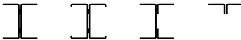
b) Avoimia yhdistettyjä poikkileikkauksia
