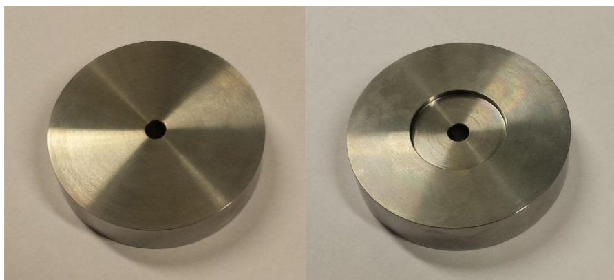
Kuva 6.12. Tappi-kiekko-koelaitteen pyörivä kiekko, jonka pintaa vasten koetappi liukuu.
