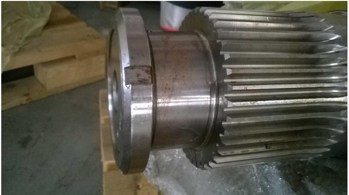
Kuva 6.20. KHW-vaihteen toisioakselin vetävä akseli (Zeng 2015).
