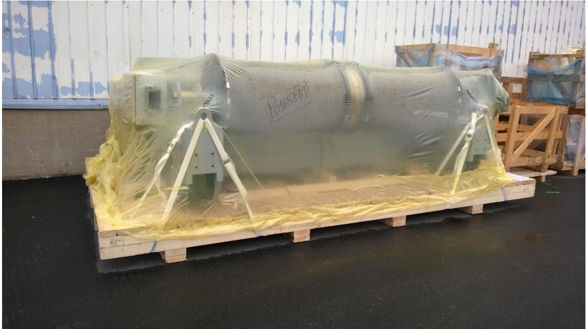
Kuva 5.5. Kuljetusta varten puulavalle pakattu ja Zerustin VCI-kalvolla suojattu vaunu.
