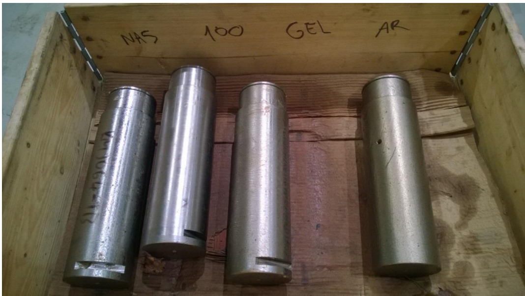
Kuva 6.15. Akseleiden ulkonäkö testin päätyttyä.
