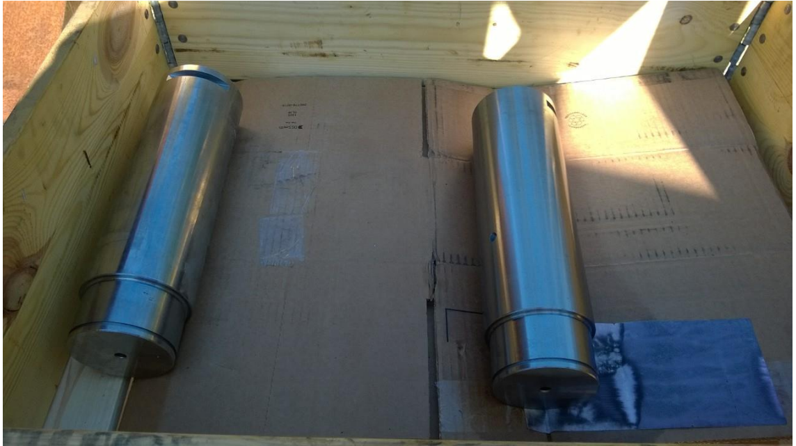
Kuva 6.17. Suojaamaton akseli (vasemmalla) ja glykolipohjaisella suoja-aineella suojattu akseli (oikealla).
