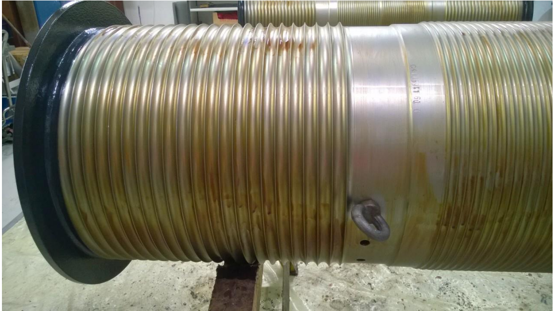
Kuva 5.2. Köysitelat, joissa köysiurat ja putken koneistetut pinnat on suojattu CRC SP 400 II:lla ja päätylaipat on maalattu.
