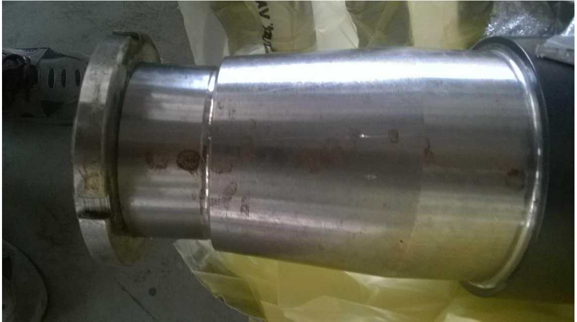
Kuva 6.21. KHW-vaihteen toisioakselin vapaa akseli (Zeng 2015).
