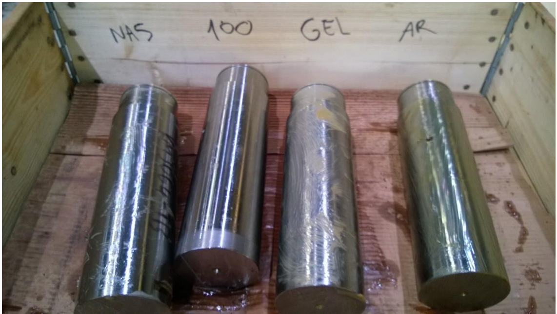
Kuva 6.12. Eri korroosionsuoja-aineilla suojatut akselit.
