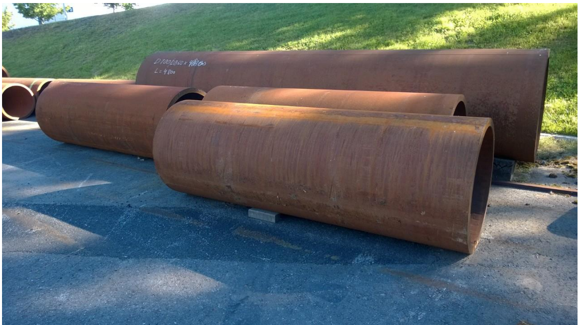
Kuva 5.1. Köysitelojen putkiaihioita varastoidaan komponenttitehtaan edustalla.
