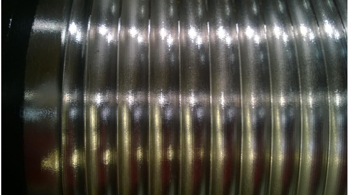
Kuva 6.10. Fluid Filmin NAS-tuotteella suojattu köysitela.
