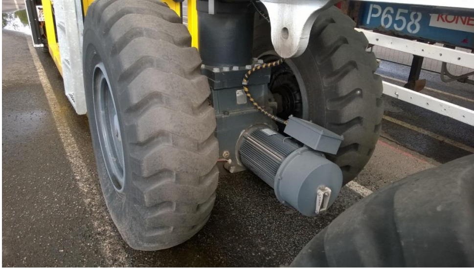
Kuva 6.2. Nosturin telin yksi pyöräpari, jossa pyörien välissä on KHW-alennusvaihde.
