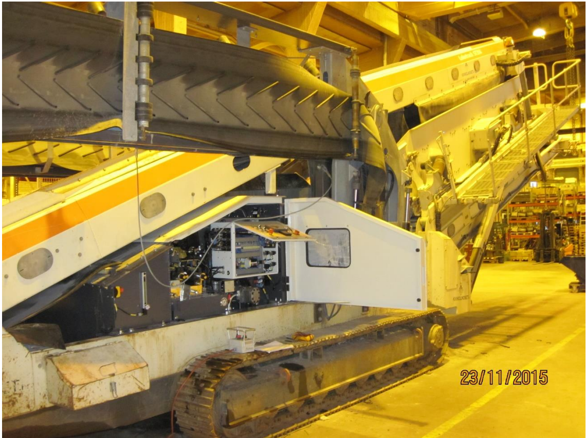
Kuva 6.3 Suunniteltu moottori moduuli asennettuna ST358:aan
