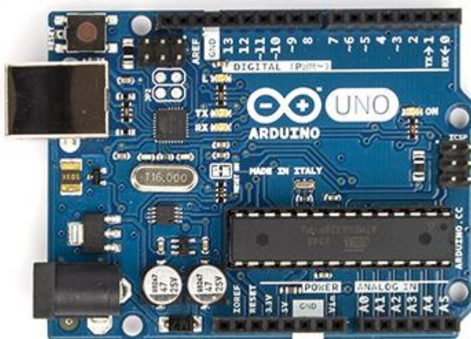
Kuva 5.5 Arduino Unon piirilevy päältä kuvattuna [10].
