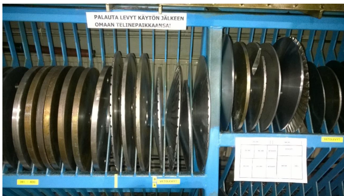
Kuva 26. Ohjaus- ja vetolevyt on järjestetty telineessä halkaisijan perusteella. Järjestyksen säilyvyyttä ylläpitää telineen jako merkittyihin halkaisijaväleihin ja kuvallinen ohje.
