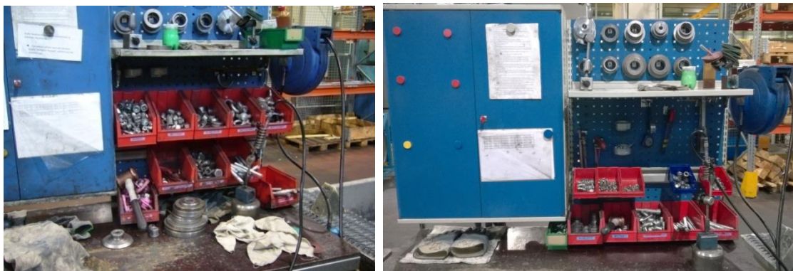
Kuva 27. Lämpäyskoneen työpöytä ennen (vasemmalla) ja jälkeen (oikealla) 5S pilottihankkeen. Ylimääräiset työvälineet on poistettu ja tarpeelliset uudelleensijoitettu laatikoihin ja pidikkeisiin.
