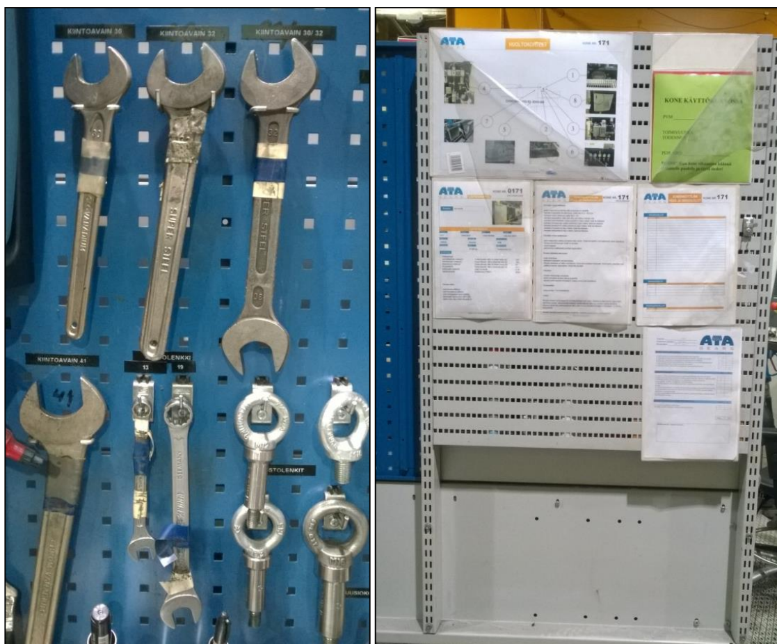
Kuva 12. Vasemmalla: Työkalut ovat sijoitettuna reikätaululle työpisteellä. Työkalujen paikat on merkitty ja itse työkalut värikoodattu teipeillä. Oikealla: Esimerkki käyttäjä-huoltotaulusta koneella.
