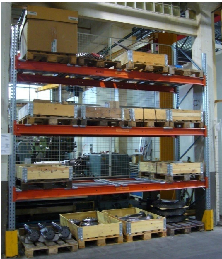
Kuva 29. Hyllyissä säilytettäviä kunnossapidollisia tavaroita, hylättyjä töitä ja testitöitä ilman lattialle näkyviä merkintöjä.
