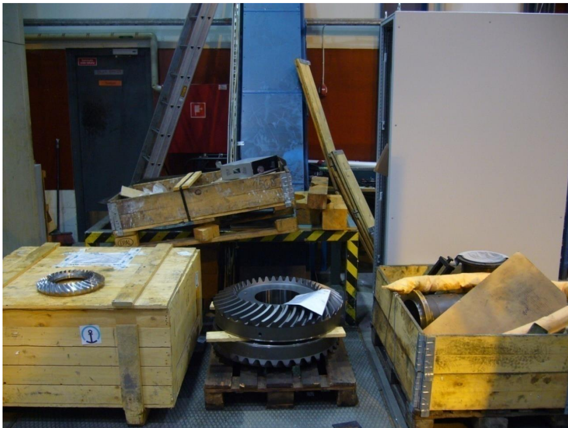
Kuva 14. Tuotantotiloihin on kerääntynyt vapaille paikoille sekalaista tavaraa. Lattialla on koneen osia, kunnossapidon tavaroita, testitöitä, lavan laitoja ja puupalikoita. Huomaa tikkaat estämässä pääsyn paloletkulle.
