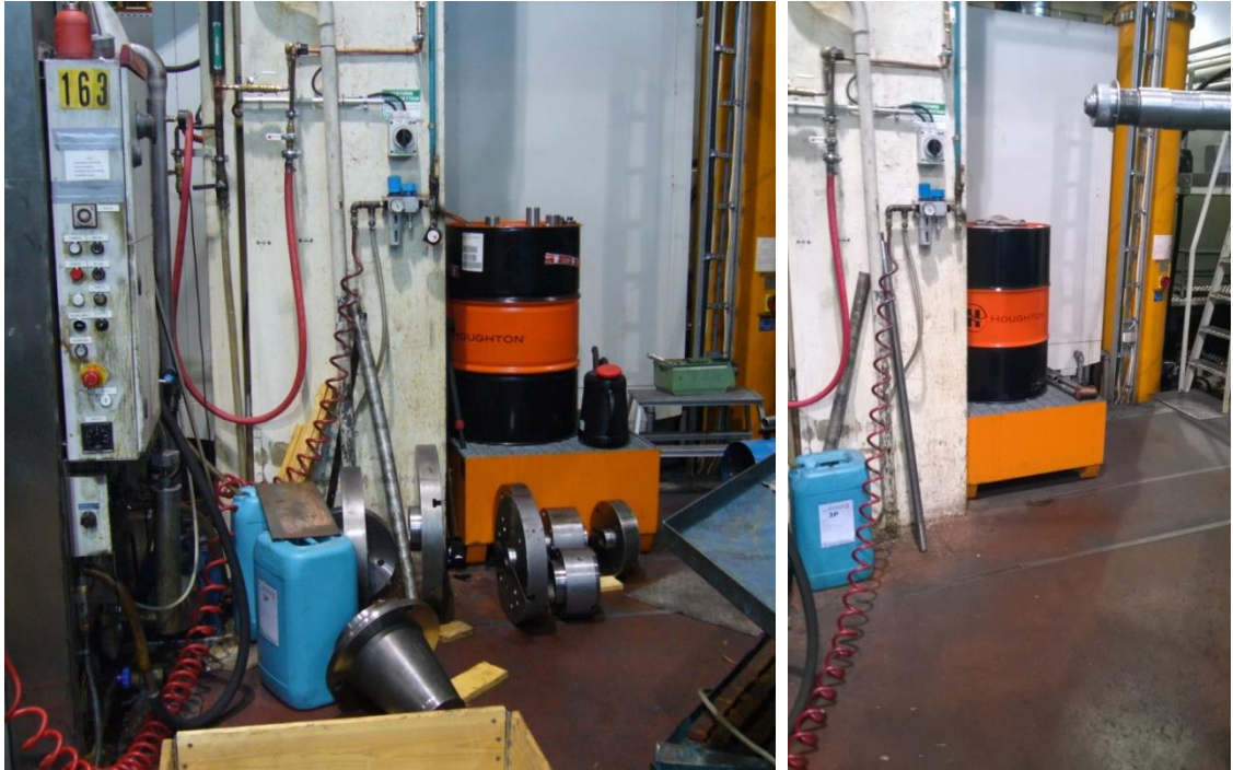
Kuva 21. Vasemmalla: Lattialla sekalaista tavaraa ja laippoja pesukoneen ja kone 40 välissä. Oikealla: Pilottihankkeen jälkeen sekalaiset tavarat on kerätty pois ja laipat uudelleensijoitettu.
