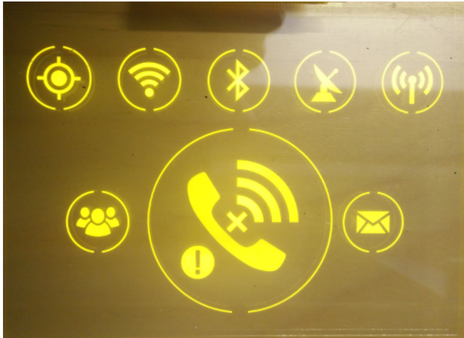
Kuva 3.6 Ensimmäinen näyttölasi, joka sisältää kommunikointiin liittyviä ikoneja.
