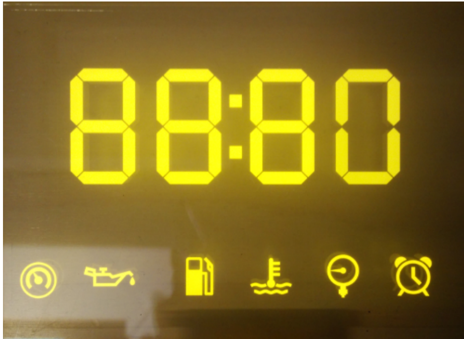
Kuva 3.9 Neljäs näyttölasi, joka sisältää traktorin tilaan liittyvää tietoa.
