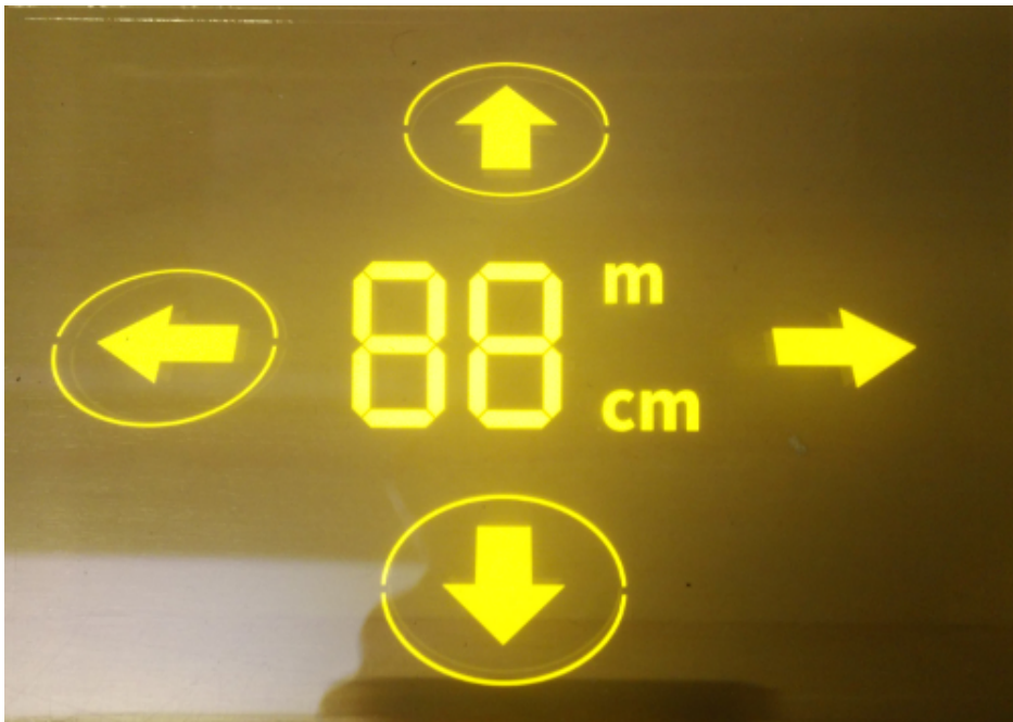
Kuva 3.8 Kolmas näyttölasi, jolla voidaan ilmaista esimerkiksi etäisyyksiä johonkin kohteeseen.
