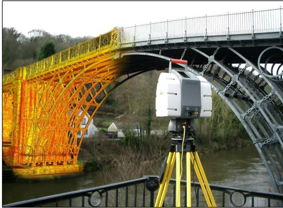
Kuva 5. Esimerkki maalaserkeilaimesta ja sen tuottamasta pistepilvestä. (rudi.net 2015)
