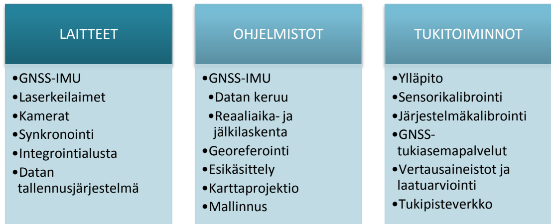
Kuva 4. Ajoneuvolaserkeilauslaitteiston eri osat. (Hyyppä ja Kukko 2010, muokattu)
