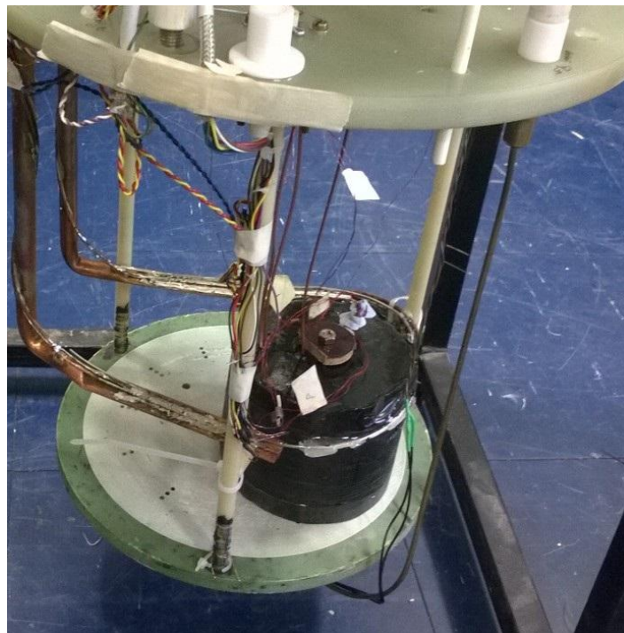
Kuva 5.5: Valokuva valmiista kryostaattiin kiinnitetystä käämistä 3, johon on kiinnitetty mittaussanturit ja lisätty kerros epoksia.
