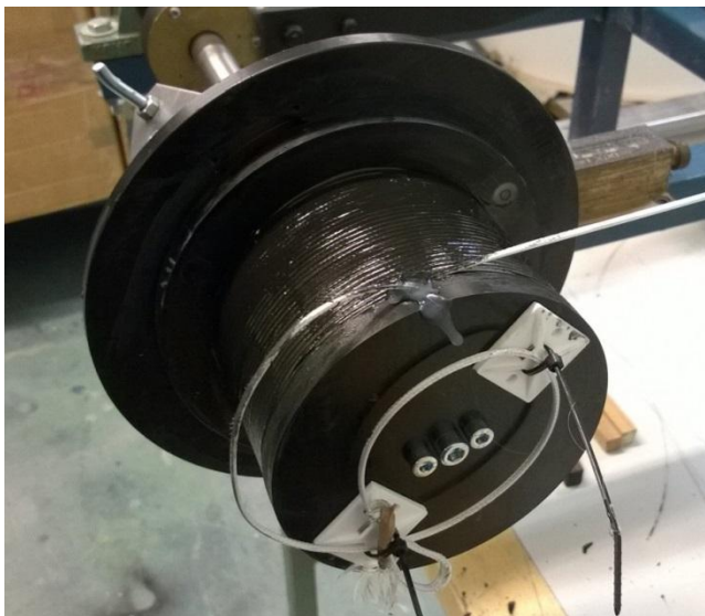
Kuva 5.2: Valokuva käämin 3 valmistuksen lopusta. Uloimmankin johdinkerroksen päälle lisättiin kerros epoksia.
