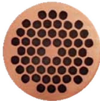
Kuva 2.3: Luvata Oy:n valmistaman 54-säikeisen suprajohtimen poikkileikkaus. Tummat alueet ovat suprajohdetta, jota ympäröi kuparinen matriisimetalli. [4]
