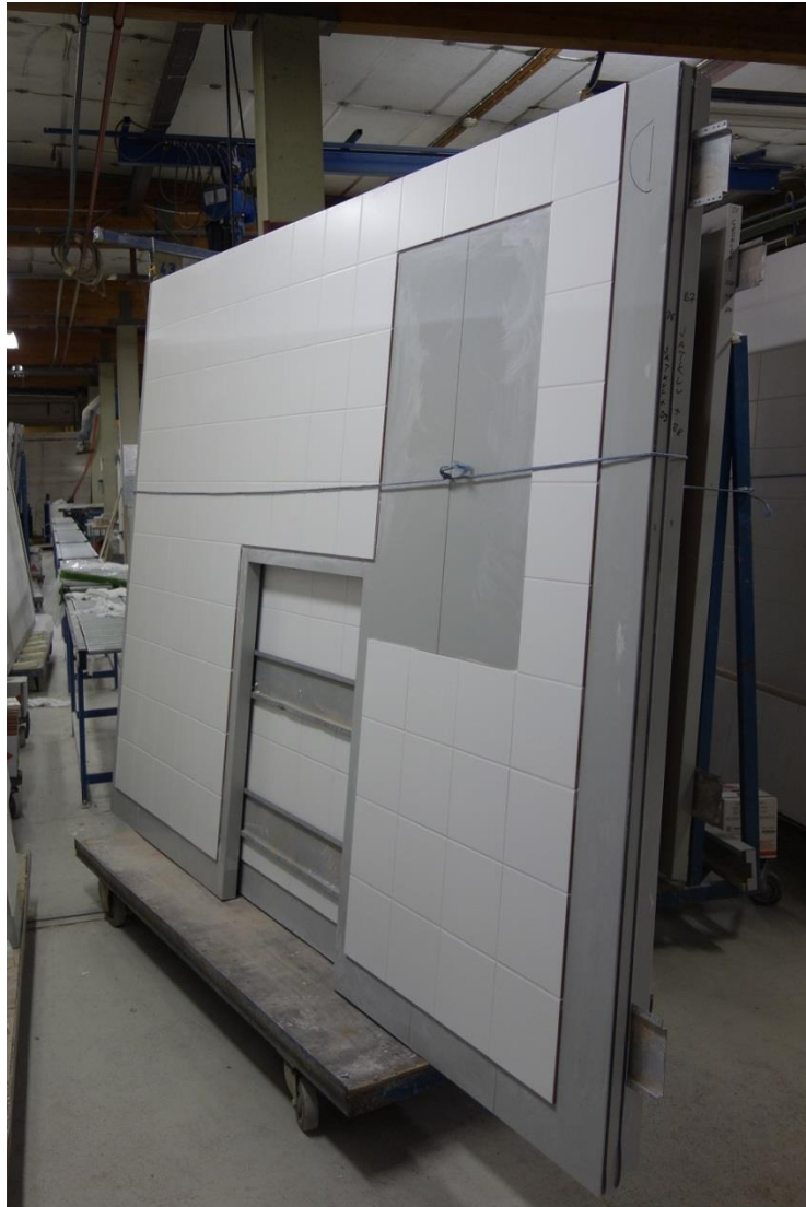
Kuva 3.5. Laatoitettu seinämoduuli. Laatoitukset jätetään tekemättä varuste- ja kalustekiinnityksien kohdalta. Kulmista seinämoduulit kiinnitetään toisiinsa ruuviliitoksin ja seinäpinta viimeistellään kulmien silikonisaumauksella.
