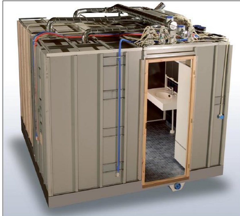
Kuva 3.1. Kevytrakenteinen kylpyhuone-elementti. Elementtiin on integroitu valmiiksi talotekniikka ja kalusteet. Kevytrakenteisen elementin seinä- ja kattorakenne on toteutettu teräsohutlevy – elementistä kokoamalla ja ainoastaan kylpyhuoneen pohjalaatta on toteutettu teräsbetonirakenteisena (Parmarine Oy, 2011).
