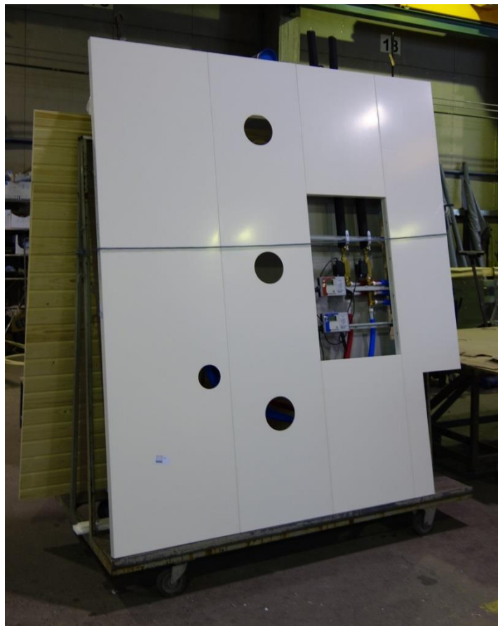
Kuva 3.7. Kylpyhuone-elementin kattomoduuli valmiina asennettavaksi. Kattoelementtiin kiinnitetään suurin osa kylpyhuoneen talotekniikasta. Tarkastusluukku tehdään aina vesimittarin kohdalle käytönaikaisia tarkastus- ja huoltotoimenpiteitä varten. Kuvassa elementin oikeassa alareunassa näkyy varaukset tekniikkahormille, valaisimille ja ilmanvaihtokanaville.
