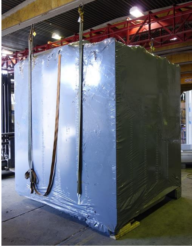
Kuva 3.8. Kuljetusta varten suojattu kylpyhuone-elementti. Kylpyhuone-elementtiin on kiinnitetty nostolenkit valmiiksi tehtaalla, jotta elementti voidaan työmaalla asentaa paikoilleen välittömästi.
