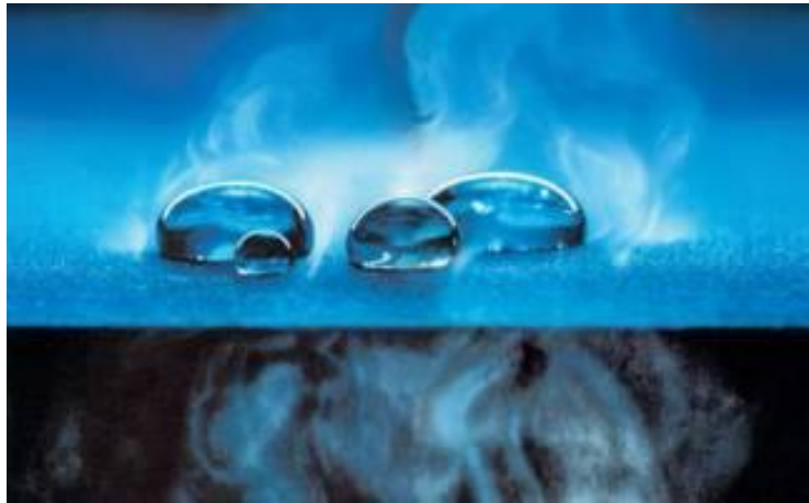
Kuva 5.5. Diffuusioavoimen polyolefiinikuidusta valmistetun aluskatteen suhteellinen diffuusiovastuskerroin S_d on 0,02 m. (RT N-37226 2006.)
