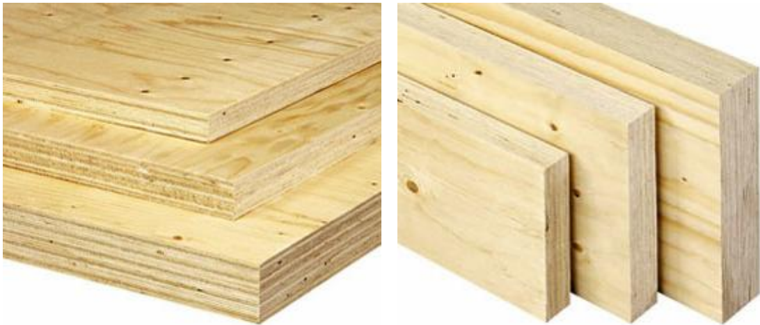
Kuva 5.30. Kertopuulevyssä (vasemmalla) viidennes puuviiluista on poikittaisia. Kertopuupalkissa ja -runkotolpassa viilujen syysuunta on pitkittäinen kaikissa kerroksissa. (finnforest 2009b.)
