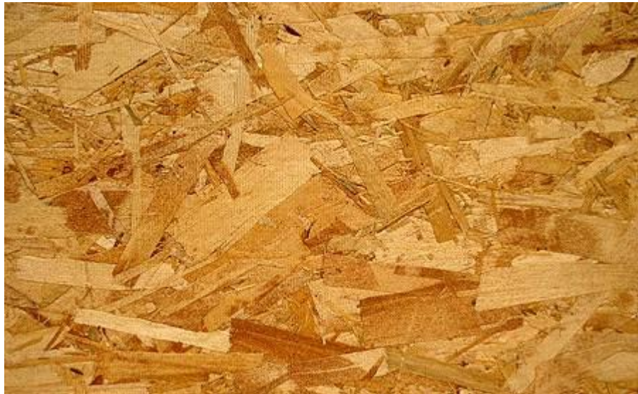
Kuva 5.33. OSB-levy koostuu 10...15 mm pitkistä ja 0,7 mm ohuista voimakkaasti yhteen puristetuista puulastuista. Lastujen leveys vaihtelee välillä 5...30 mm. (Pro Puu r.y. 2004a.)
