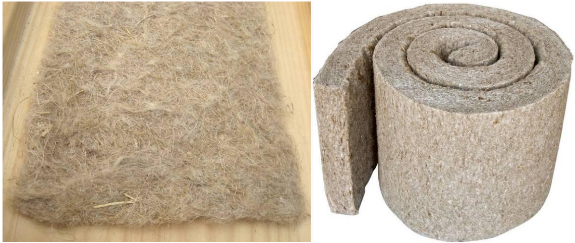
Kuva 5.18. Vasemmalla hirsien saumoissa käytettävää pellavasta valmistettua nauhaeristettä, jossa näkyvät hyvin pellavan puumaiset kuidut. Vieressä pellavakuiduista valmistettu eristelevy: (Domus Classica Oy Ltd 2010.)
